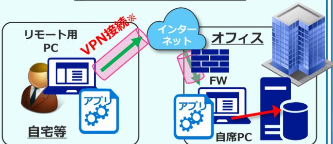
リモート用PCと自席の自分のPCに、ソフトウェアVPNのアプリケーションを導入します。オフィス内の自席のPCは常時電源ONとしておき、リモート用PCからVPN接続する方式となります。
