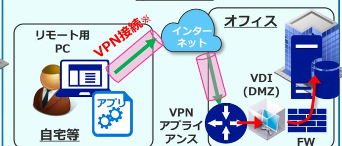
VPN接続用のアプリアプライアンスとVDIを導入します。リモート用PCでVPN接続を行い、VDIに接続します。VDIにログインすることで、社内のPCと同様の環境で利用可能となります。
