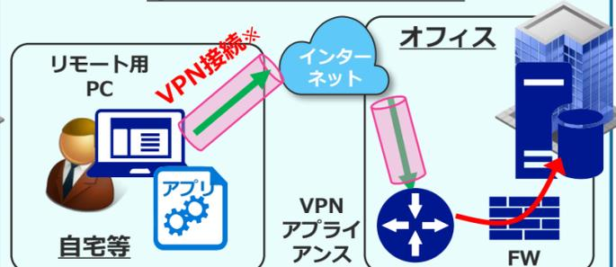
VPN接続用のアプリアプライアンスを導入し、VPN接続用のアカウントを作成します。次に、リモート用PCにVPN接続のアプリケーションをインストールします。
